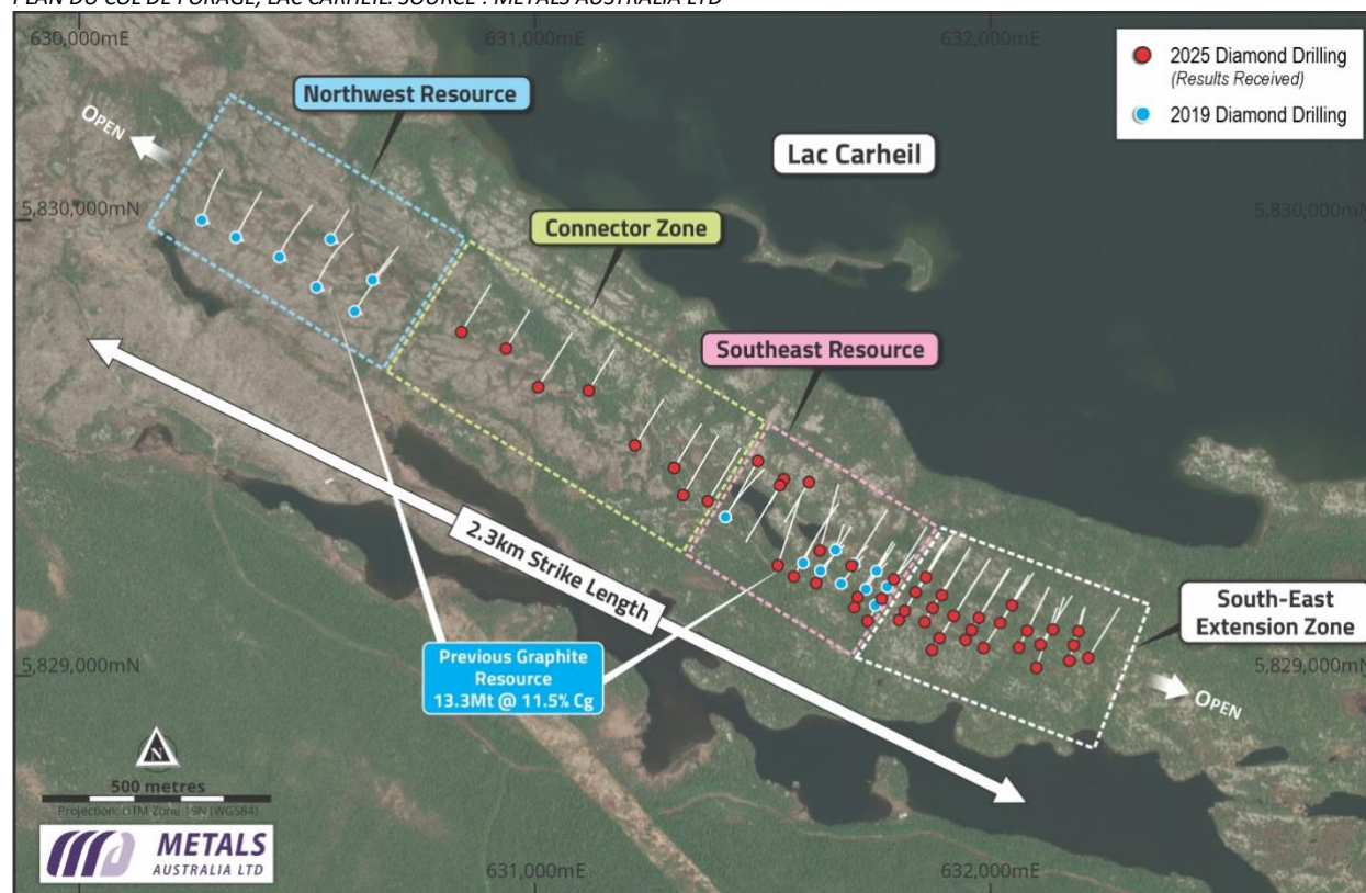
PLAN DES COLLIERS DE FORAGE ET BLOCS DU MODÈLE DE RESSOURCES MINÉRALES, LAC CARHEIL. SOURCE : METALS AUSTRALIA LTD
